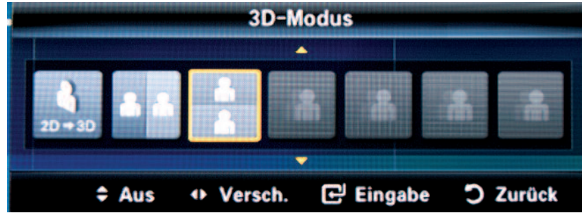
Das Setup für 3D-Signale ermöglicht neben der automatischen Funktion die Fixierung auf alle heute bekannten 3D-Formate.
