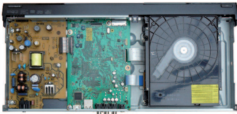
Der UniPhier-Prozessor ist kopfüber montiert und erhält seine Kühlung durch den Gehäuseboden. So kann auf einen Lüfter verzichtet werden.
