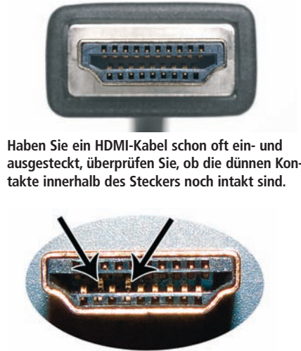
Ist der Stecker defekt, sind die Kontakte innerhalb des Steckers häufig nach hinten gebogen.
